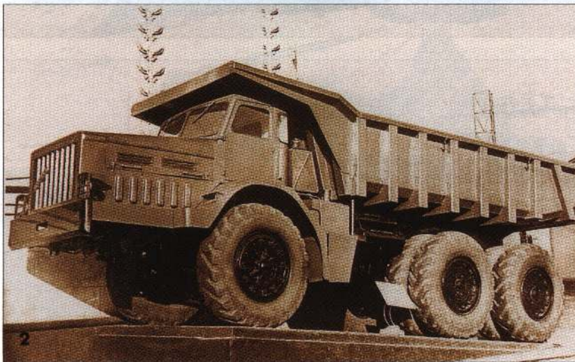
2. Последний вариант 40-тонного карьерного самосвала, уже имел марку БелАЗ-580 – фары, установленные отдельно, и иную форму верхней части капота. Фото из архива А.С. Исаева
