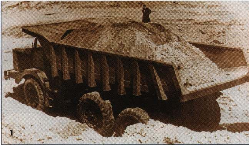
1. МАЗ-530 вывозит песок на открытых разработках фосфоритной муки в подмосковном Воскресенске. Фото с разрешения Е.С. Бабурина
